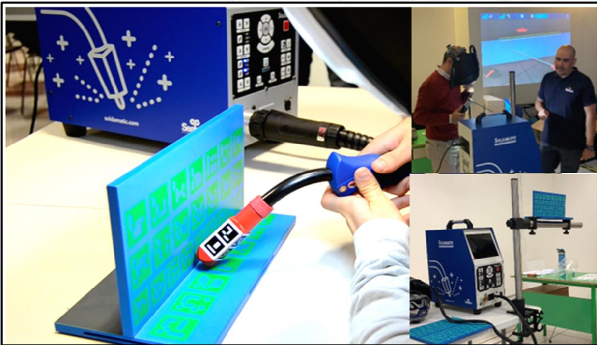
Fig. 35: Simulador de soldadura al arco, carrera de Mantenimiento Industrial CFT Estatel Región de Coquimbo.
